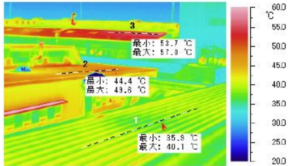
写真4 各種塗装をした金属折板屋根の熱画像
