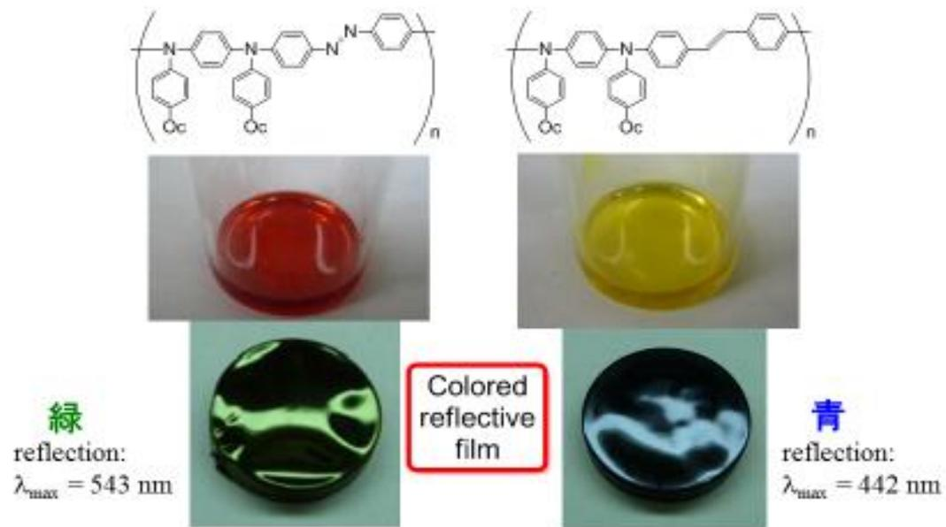
図1 ポリアニリン類緑体：溶液とフィルムの外観
