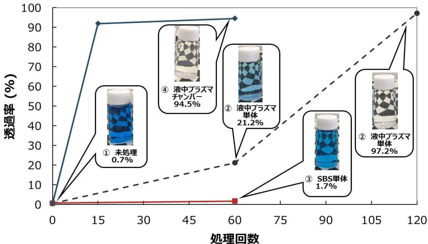
図5 各メチレンブルーサンプルの処理回数毎の透過率の変化
