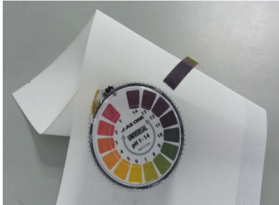
図4 水で濡らした漆喰塗膜表面によって、pH試験紙の色が黄色(pH=7) → 紫色(pH=11以上)に変化する様子
