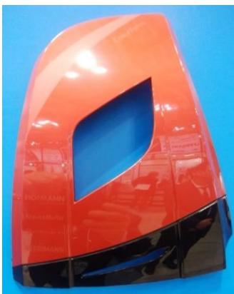
図24 インモールド塗装による塗装代替自動車外板検討、採用例(欧米)
