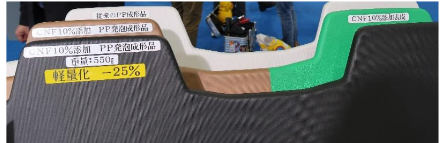
CNF(セルロースナニファイバー)発泡成形
