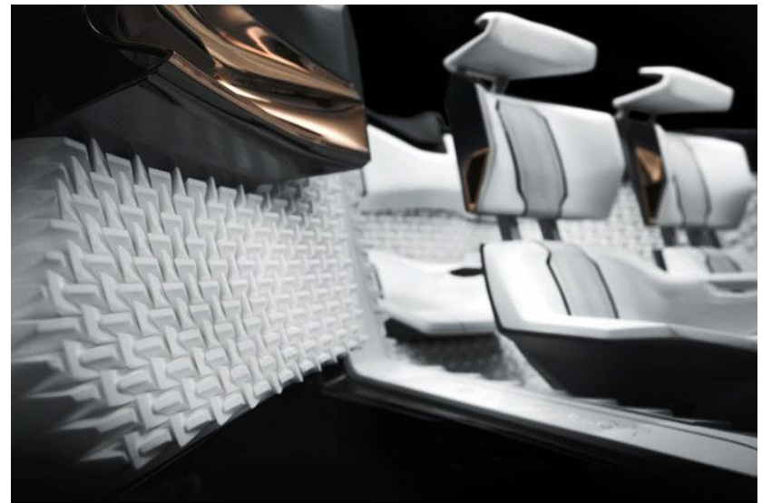
プジョーのコンセプトカー「フラクタル」のドア内張り。優れた音響効果をもたらすという複雑な形状
